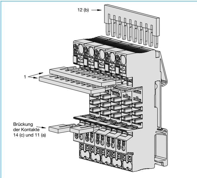
**Kodierung REF16-S und Stecksockel 80plus nach dem Schlüssel-Schloss-Prinzip**
