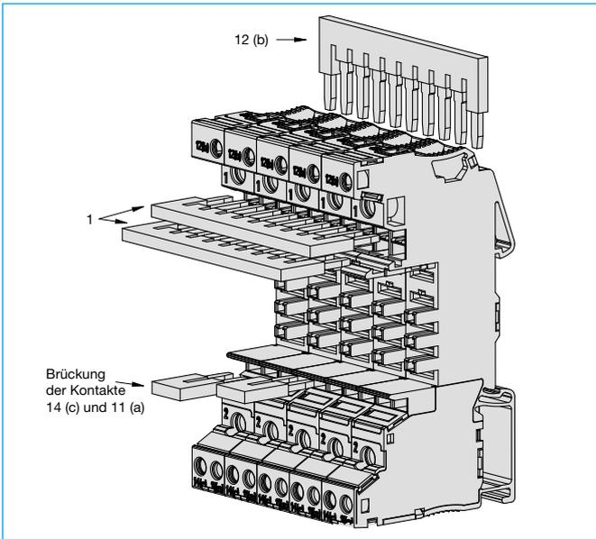
**Kodierung REF16-S und Stecksocket 81plus nach dem Schlüssel-Schloss-Prinzip**
