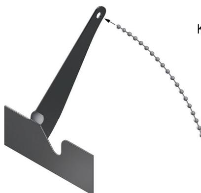
Kette in Kettenschloss einsetzen
